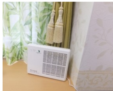
オゾン発生器(全21台設置)
