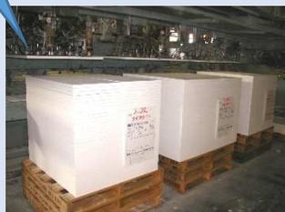
施工図に基づきプレカット出荷し、現場廃材の極小化します。環境にやさしくて、コスト削減になります
